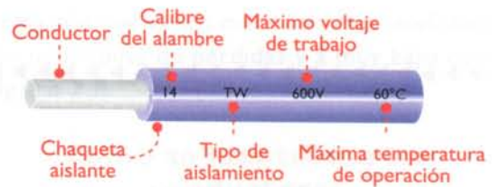
Figura 3.1. Estructura básica del alambre
